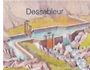
L'eau déviée dans le canal par la prise peut transporter des quantités importantes de matière en suspension (boues) et des sédiments (sable, gravier) qui doivent être éliminés, sans quoi, ils combleront le canal et endommageront rapidement les vannes et la turbine.
