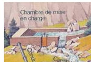
C'est un petit bassin qui permet de garantir que la conduite forcée est en tout temps en eau. Elle fonctionne comme tampon entre la prise d'eau et la conduite.
